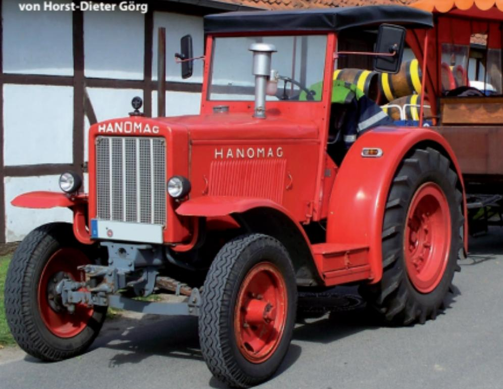
Mit dem Diesel-Radschlepper R 40 gelang der Hanomag in der schweren Kriegs- und Nachkriegszeit der entscheidende Durchbruch bei der Landmaschinenfertigung. Auch mit Holzgas-Generatoranlage fand er seine Kunden in über fünfzig Ländern der Erde. Wie schon bei den Automobilen, machte der Grafiker Heinz Brüning die Traktoren der Hanomag mit ansprechend gestalteter Werbung bekannt.
