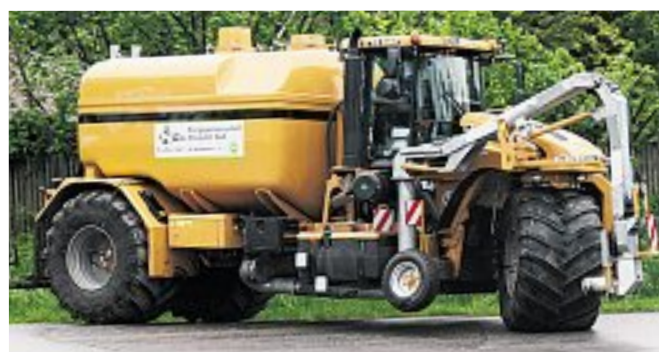
Aktueller Terra Gator der Düngegemeinschaft ist diese 3-Rad-Ausführung. Kaufargument gegenüber dem 4-rädrigen Vorgängermodell war die enorme Wendigkeit.
