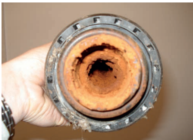
Abb. 59: Ein zu hoher Eisengehalt im Tränkwasser kann nicht nur zur Geschmacksveränderungen führen, sondern auch die hydraulische Leistung stark beeinträchtigen. (Quelle: P. Münster)
