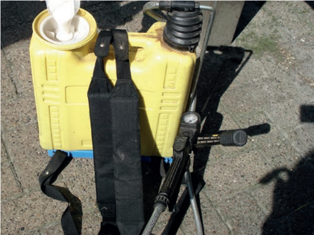
Abb. 34: Insektizide können an relevanten Stellen mithilfe einer Rückenspritze aufgetragen werden. (Quelle: P. Münster)
