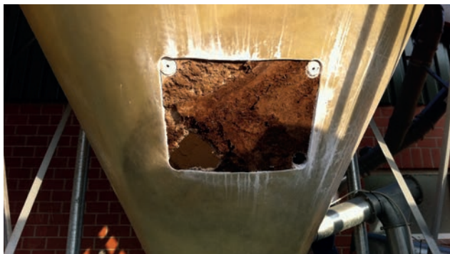
Abb. 53: Der Einbau einer Zugangsöffnung ermöglicht nicht nur die ordnungsgemäße Reinigung des Futtersilos, sondern erleichtert auch die visuelle Kontrolle, ob Ablagerungen vorhanden sind. (Quelle: U. Gonsch)
