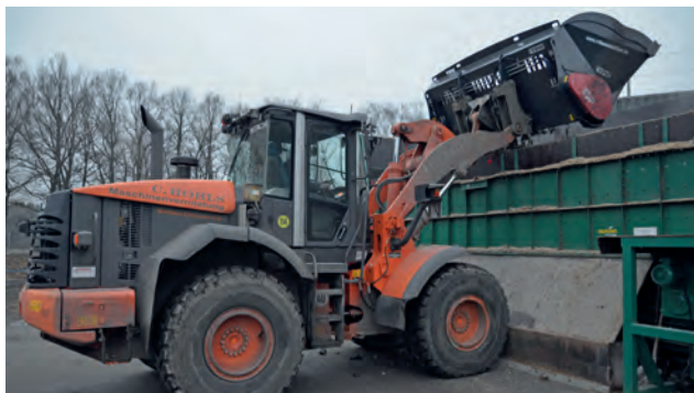
Abb. 3: Das Befüllen der Biogasanlage über Feststoffdosierer
