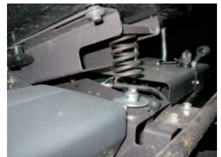
Spiralfedern ohne Dämpfer haben im Profieinsatz nicht zu suchen.
