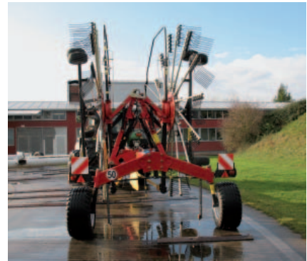
Der Mittelschwader musste die „Via Dolorosa“ insgesamt 13.500mal durchlaufen. Das große Foto zeigt den Schwader in Vorgewendestellung.
