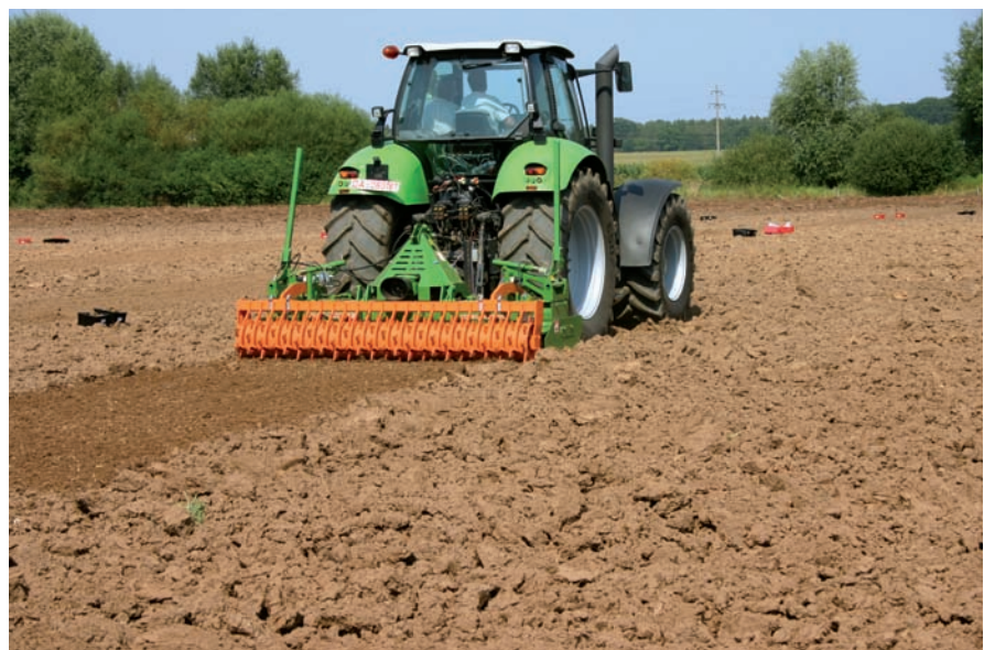
Dank eines neu entwickelten Getriebes spart die KE 3000 Super Kraft und damit Dieselkraftstoff.
